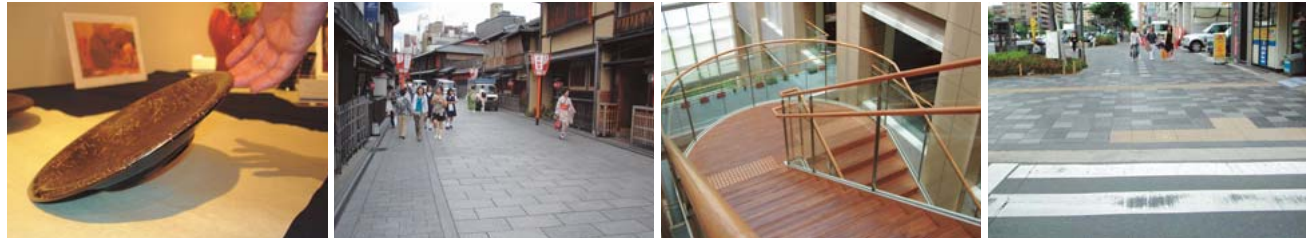
左より：素焼きの陶器に漆を塗り重ねた陶胎漆器。緑に丸みをつけることで、持ちやすく、運びやすい形になっている／景観や歩きやすさに配慮して電線類を地中化した祇園花見小路通／東山区役所の2段手すりの階段／少ない段差を望む車いす利用者と、段差を目印にする視覚障害のある人双方にとって通行しやすいよう、段差を1センチに調整した
