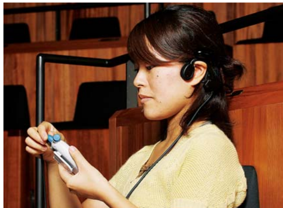
兵庫県立芸術文化センターでは赤外線発信による聴覚補助を行うためのシステム、骨伝導ヘッドセットとタイループが導入されている
