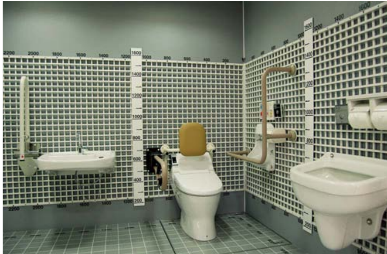
トイレ検証スペース
