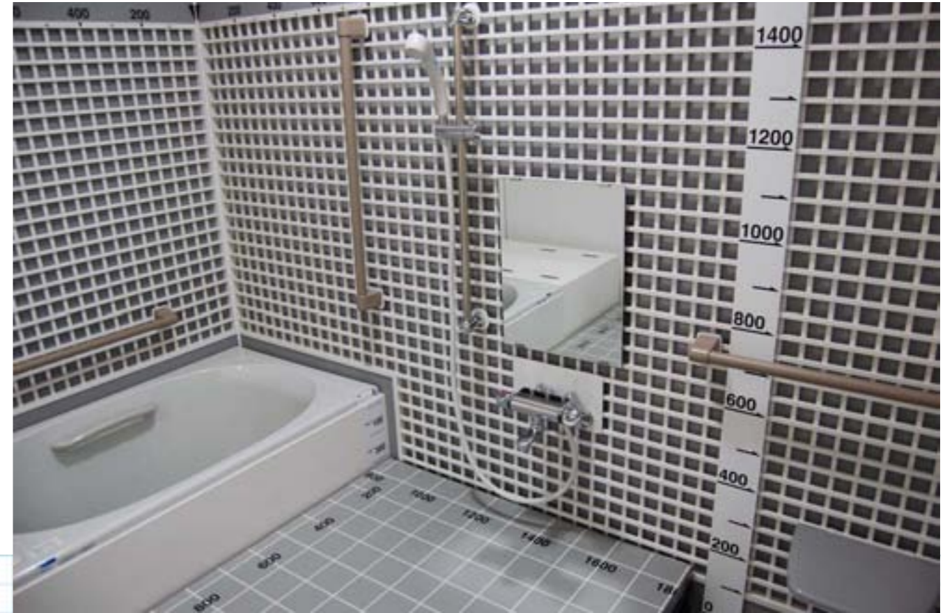
浴室検証スペースでは、水栓金具・シャワー・鏡・手すり、そして床の高さなどをトータルに確認できる
