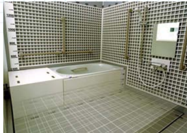
浴室検証スペースでは浴槽に対する床面の高さを変えて検証できる
