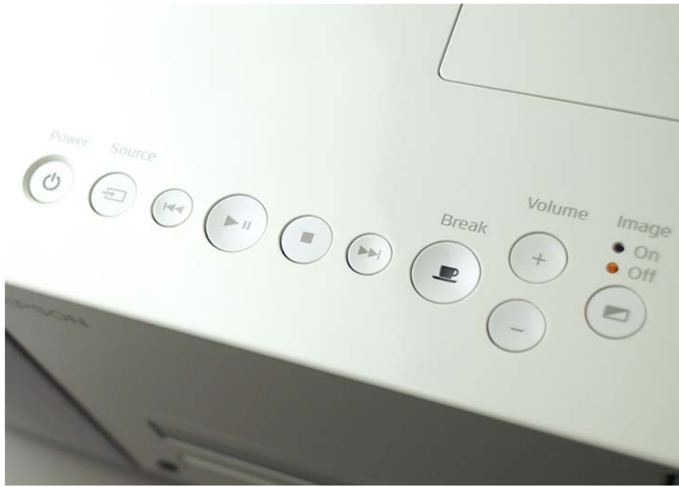
いつでも、どこでも、誰にでも使える手軽さを追求したホームプロジェクターの操作パネルにもUDフォントが使われている
