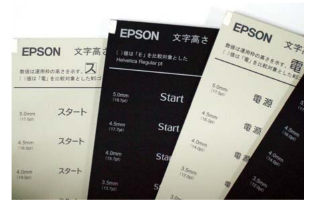
背景が白と黒の場合で、UDフォントがどれくらいまで小さくして読めるのかを確かめるためにシートを使って検証を行った
